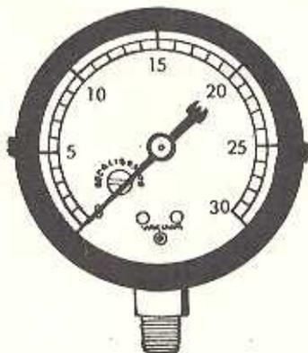
FIG. 2. MARSH GAUGE WITH CALIBRATION SCREW (07064-30301).
