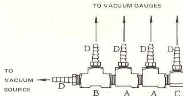
FIG. 4. CALIBRATION MANIFOLD
